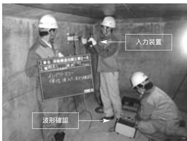
写真3 衝撃弾性波法（インパクトエコー法）
