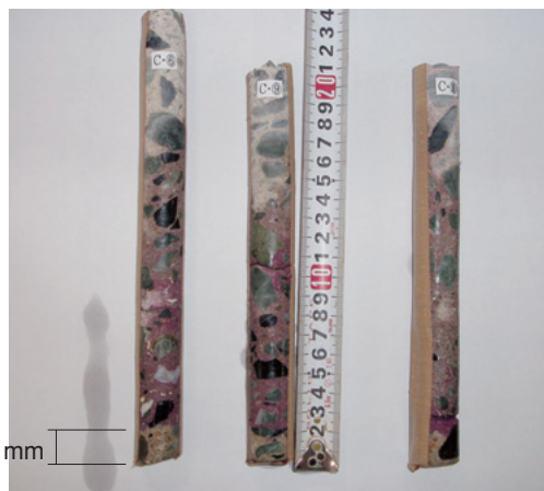
写真3 中性化試験（フェノールフタレイン溶液噴霧）
