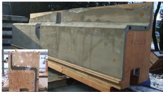
写真3 ゲルバー充填試験実物大供試体
