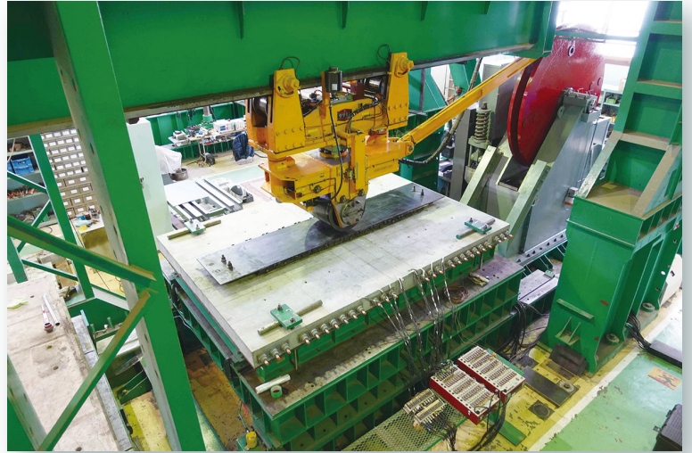
輪荷重走行試験の状況
