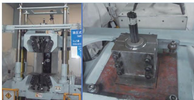
中間定着具を取り付けたPC鋼材を引張試験機にセットし、規格引張荷重の95% (664kN) まで載荷し、PC鋼材の滑り、定着具の変形・損傷のないことを確認しました(土木学会規準に準拠)。
