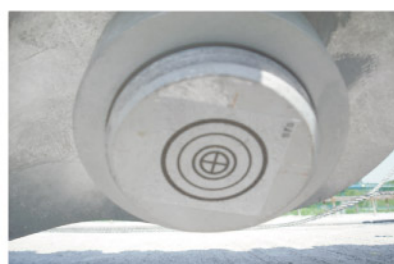
②シールターゲット添付状況
